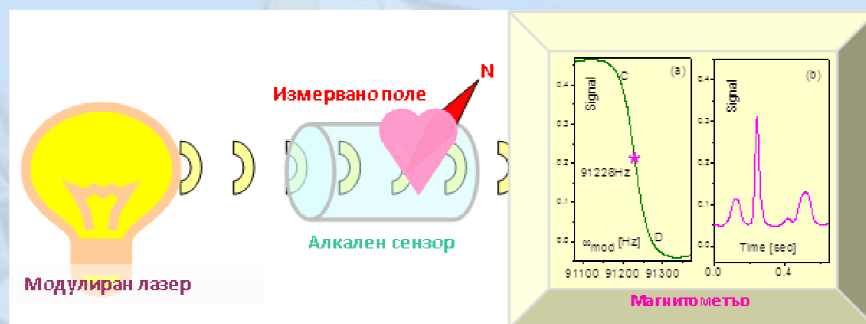
Принципна схема на измерване на магнитното поле породено от дейността на човешкото сърце
