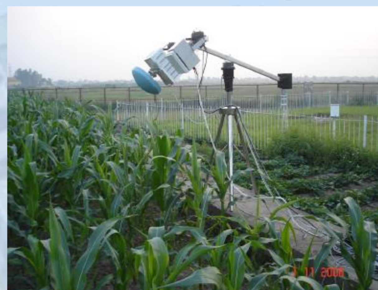
Радиометрично изследване на царевица, Ноаї Duc, Виетнам (2006 г.)
